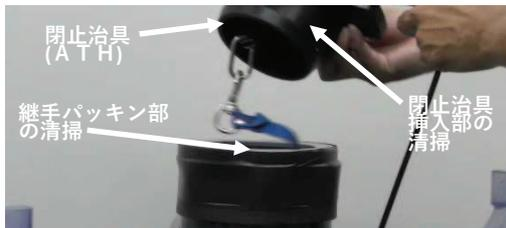
④ エアホースと安全ロープを継手内に収納して閉止治具をセットする
