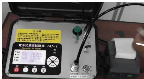
⑩ 開閉レバーを「開」にして、継手内の圧力を抜き、治具を外す
