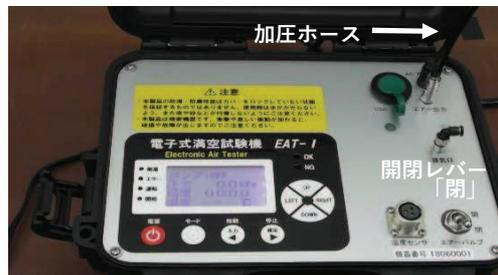
加圧ホースを本体に接続し、「始動」を押して試験を開始する
